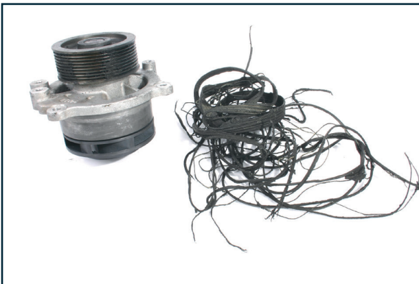
falsche Riemen ­ spannung incorrect belt tension
