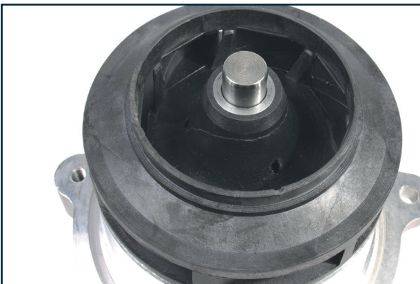
Beschädigung während Lagerung/Transport damage during storage/transport
