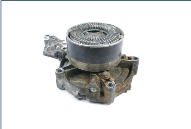
falsche Riemen ­ spannung incorrect belt tension
